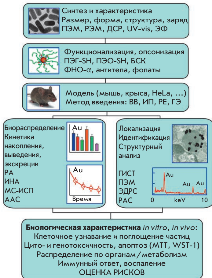
Рис. 11. Схема экспериментов по биораспределению. Первый этап включает синтез наночастиц и их характеристику (определение размера, формы, заряда и т.д.) методами электронной микроскопии (ПЭМ, РЭМ), динамического светорассеяния (ДСР) и UV-vis-спектроскопии поглощения и рассеяния на уровне суспензий или отдельных частиц, электрофореза (ЭФ) и другими методами. На втором этапе проводится функционализация поверхности частиц требуемыми лигандами, например тиолированными молекулами ПЭГ (ПЭГ-SH), полиэтиленоксида (ПЭО-SH), белками сыворотки крови (БСК), фактором некроза опухоли (ФНО- \alpha ) и т.п. Полученные конъюгаты вводятся в модель (мышь, крыса и т.д.) в соответствии с дизайном опыта (дозы, кратность, способ введения – внутривенный (ВВ), внутрибрюшинный (ИП), респираторный (РЕ), желудочно-кишечный (ГЭ)). Распределение по органам и кинетика накопления / выведения наночастиц осуществляется по выбранной схеме отбора проб, которые анализируются методами радиоактивного анализа (РА), инструментальной нейтронной активации (ИНА), масс-спектрометрии с индуктивно связанной плазмой (МС-ИСП) или атомно-адсорбционной спектроскопии (ААС). Проводится также идентификация частиц на тканевом (гистология, ГИСТ) и клеточном уровне и локализация ЗНЧ с использованием методов ПЭМ, энергодисперсионной рентгеновской спектроскопии (ЭДРС) и рентгеновской адсорбционной спектроскопии (РАС). На последнем этапе проводится биологическая характеристика, включая оценку проникновения в клетки, цито- и генотоксичности, апоптоза (с использованием стандартных тестов MTT и WST-1) и т.д., с финальной оценкой возможных рисков. Воспроизведено из работы [248] ( http://dx.doi.org/10.1039/c0cs00018c ) с разрешения The Royal Society of Chemistry.
