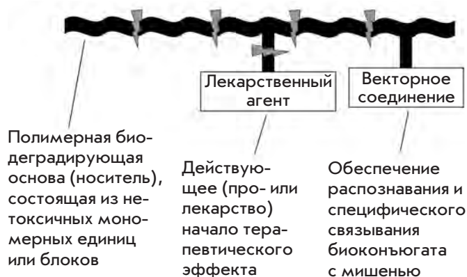
Рис. 5. Схематическое представление модели биоконъюгата для направленного транспорта лекарств в организме. С биodeградируемой матрицей полимерного носителя ковалентно связаны векторная и лекарственная части биоконъюгата.
